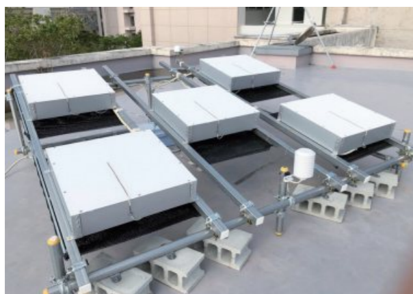
遮熱塗料の暴露試験
