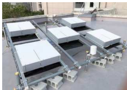
遮熱塗料の暴露試験
