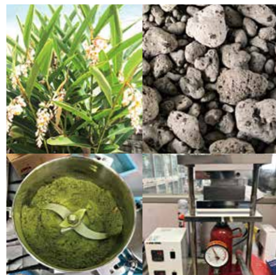
「しまボタニカルコンクリート」の製造工程。月桃や軽石を粉碎し、熱プレスをかける
