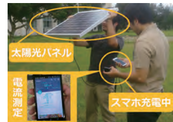
図1 太陽電池によるスマホ充電 Fig. 1: Recharging a smartphone with a solar battery
