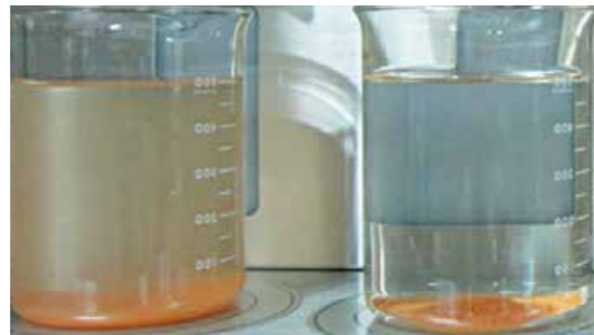
図2:オキナワモズク凝集剤(FM)の凝集活性試験 FM添加量0 ppm(添加なし)(右)および50 ppm(左)
