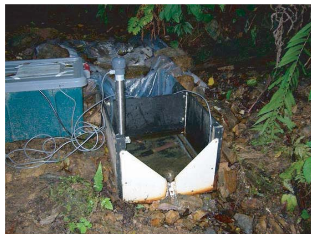
写真3 流域出口における水文観測（流域出口に設置したVノッチ堰）
