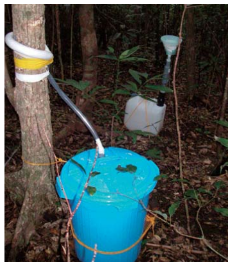
写真1 森林における降雨遮断の観測
