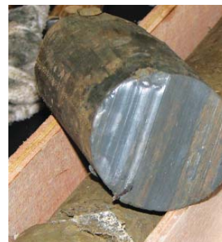
写真3 安里地すべりのすべり面
