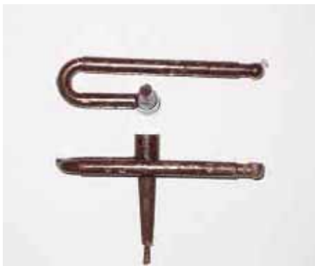
写真3 月桃繊維を用いた繊維強化プラスチック
