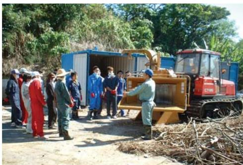
大型トラクタに取り付けられたPTO式チッパー（粉碎機）
