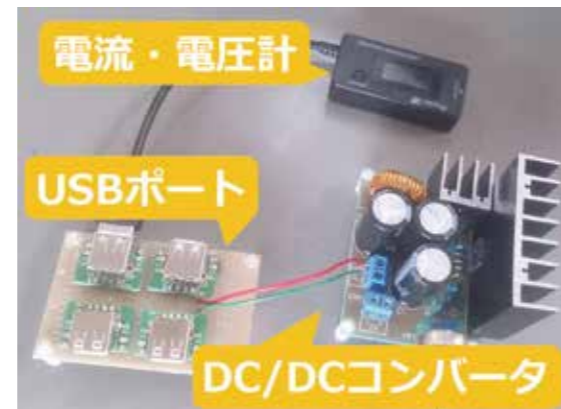
図2 太陽電池の周辺機器
