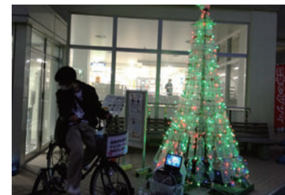
図4 自転車発電機によるLED電飾の点灯
