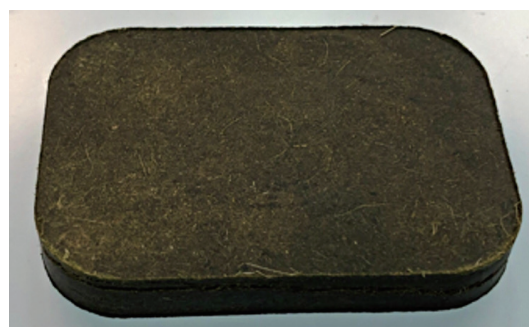
月桃を原料とした「しまボタニカルコンクリート」
