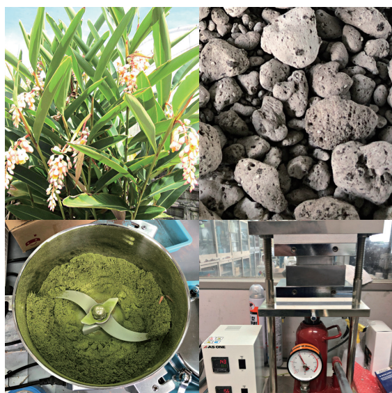
「しまボタニカルコンクリート」の製造工程。月桃や軽石を粉砕し、熱プレスをかける
